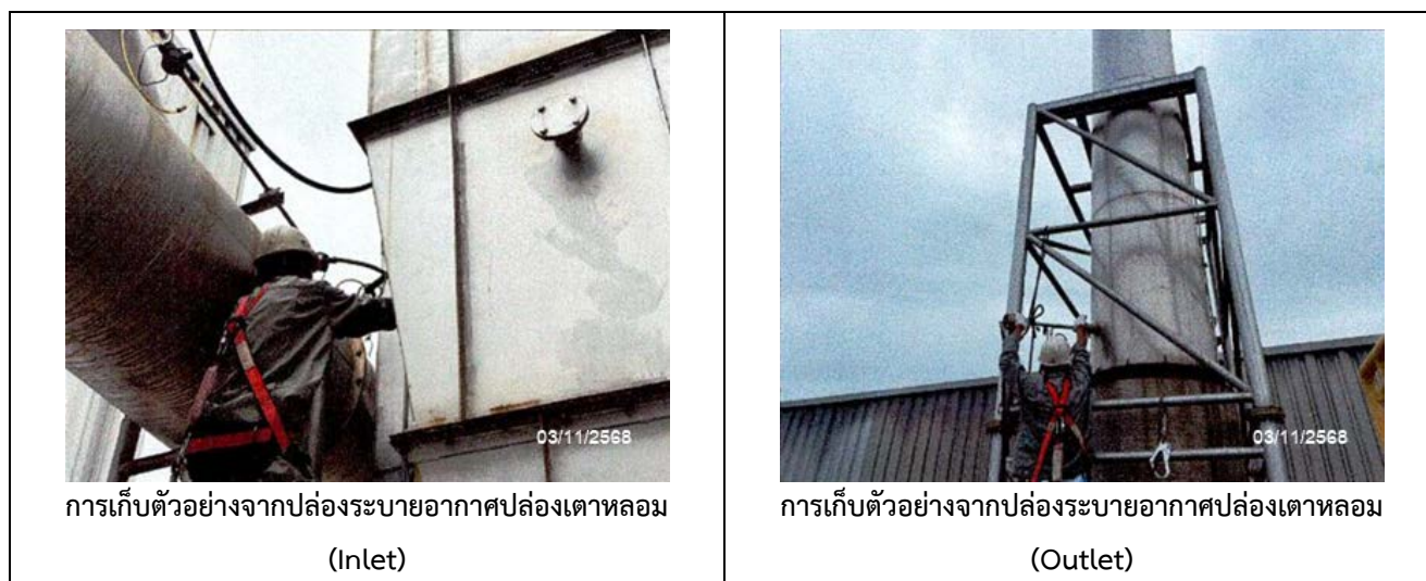
รูปที่ 3.4.1-1 การเก็บตัวอย่างปล่อยระบายอากาศเสียจาก Bag Filter ชุดที่ 1 บริเวณอาคาร Diecast 1 (DC1)
